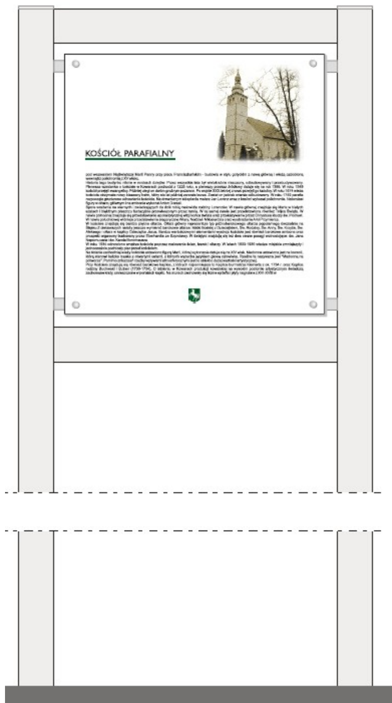
2940 mm x 610 mm wymiar tablicy poliwęglanowej 450 mm x 450 mm
